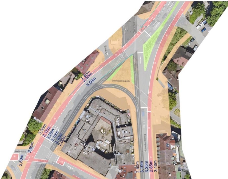
Abbildung 26 Knotenpunktgestaltung Schwabentorplatz (Variante 2) (Quelle: INOVAPLAN GmbH)
