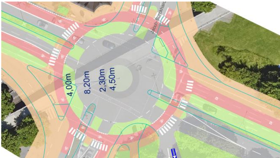
Abbildung 16 Knotenpunktgestaltung Jacob-Burckhardt-Straße (Variante 1) (Quelle: INOVAPLAN GmbH)
