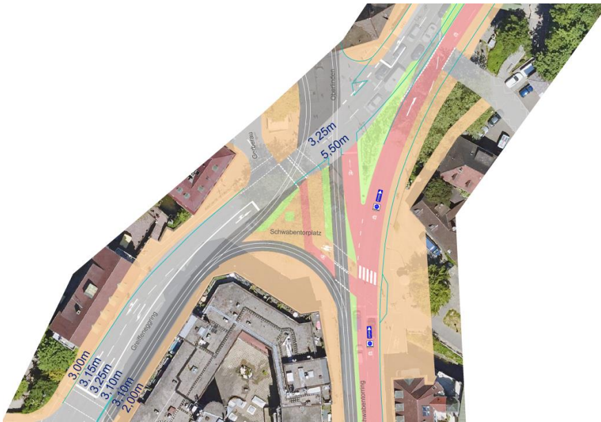
Abbildung 23 Knotenpunktgestaltung Schwabentorplatz (Variante 1) (Quelle: INOVAPLAN GmbH)
