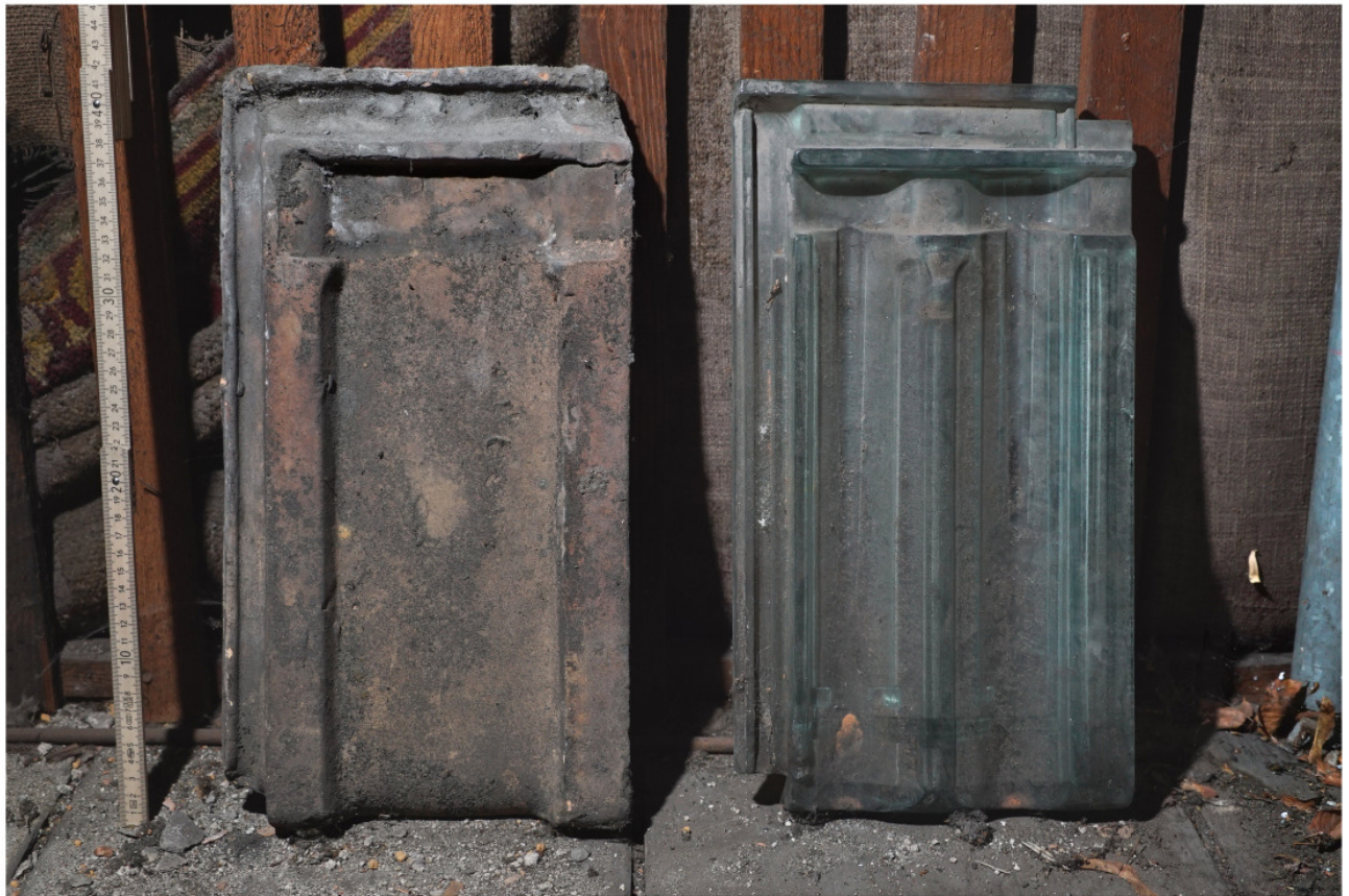
Falzziegel und Glasziegel, Außenseiten, Falzziegel 43/23,5 cm, Verlegemaß 33/20,5 cm
