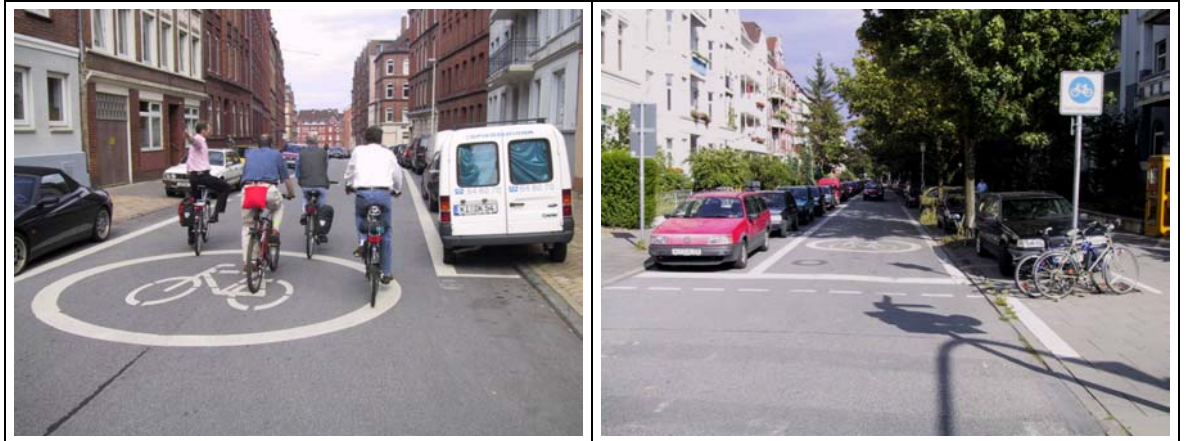
Bild 7-13: Beispiel Kiel Fahrradstraßen mit Fahrbahnrandmarkierung und großem Piktogramm an allen Knotenpunkten
