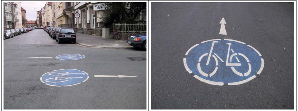
Bild 7-10: Beispiel Hannover Piktogramme in Blau mit zusätzlichen Richtungspfeilen an allen Einmündungen
