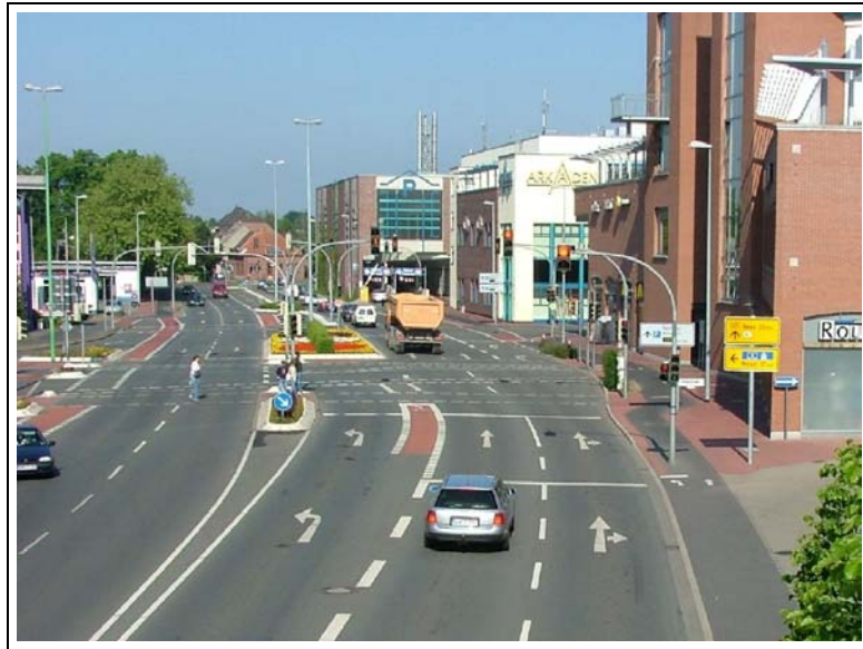
Bild 9-12: Beispiel einer Radfahrschleuse (Bocholt, Foto W. Angenendt)
