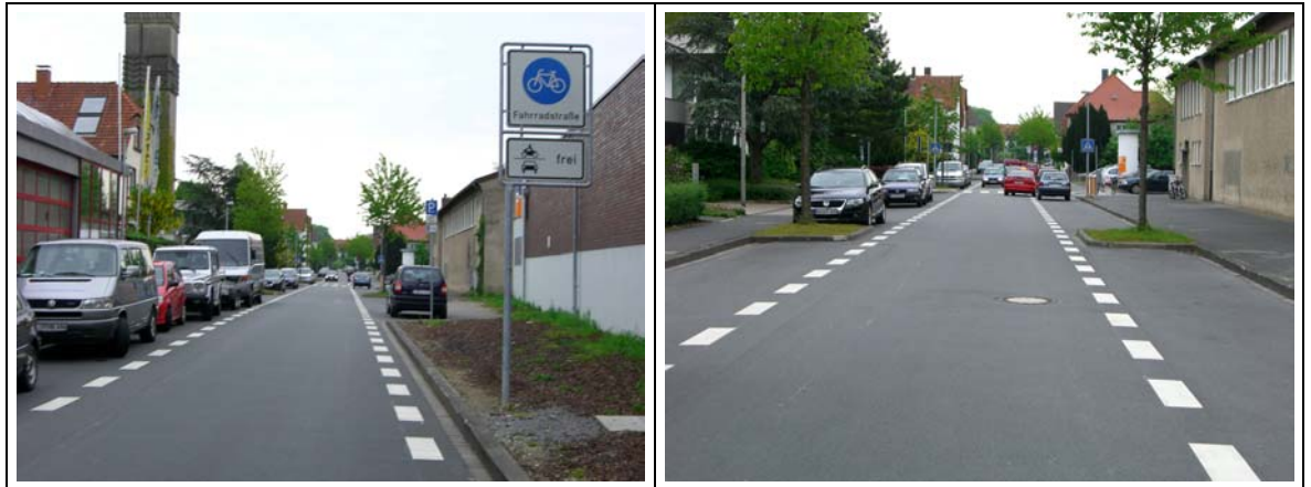
Bild 7-8: Beispiel Lemgo Fahrgasse (3,5-4 m breit) mit Breitstrichmarkierung (1 m Strich, 1 m Lücke) Auf diesen Fotos fehlen noch die Piktogramme auf der Fahrbahn Punktuelle Gehwegnasen zur Unterbrechung des linearen Parkens am Fahrbahnrand
