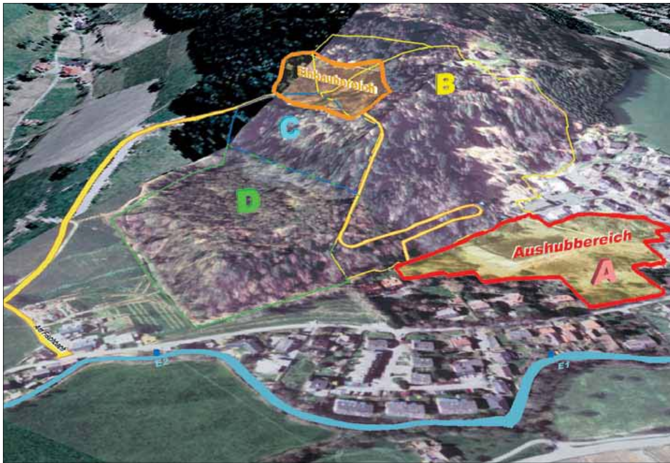
Der Übersichtsplan zeigt den Aushubbereich (A, rot) und den Ablagerungsbereich (ocker) sowie die beiden Baustreifen (gelb), über die das Aushubmaterial (Mitte) und das Abdeckmaterial (links) transportiert wird. Mit B, C und D sind die Planungsbereiche bezeichnet. (Grafik: HPC AG)
