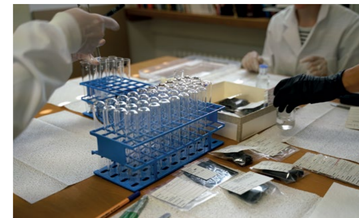
Vorbereitungen für den Oddy-Test, Foto: Städtische Museen Freiburg
