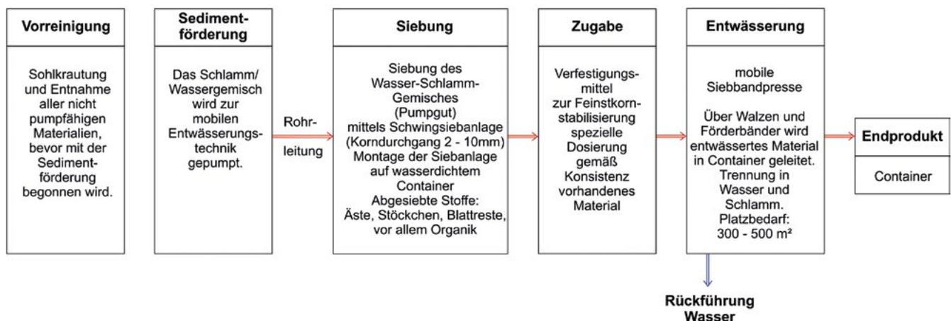
Bild 7: Schema Entwässerung
