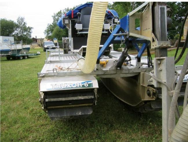
Bild 9: schwimmfähiges Gerät „Truxor 5045“ Die Zahl 6 ist eine interne Bezeichnung der Vebiro GmbH. (Foto vom 20.7.2017)
