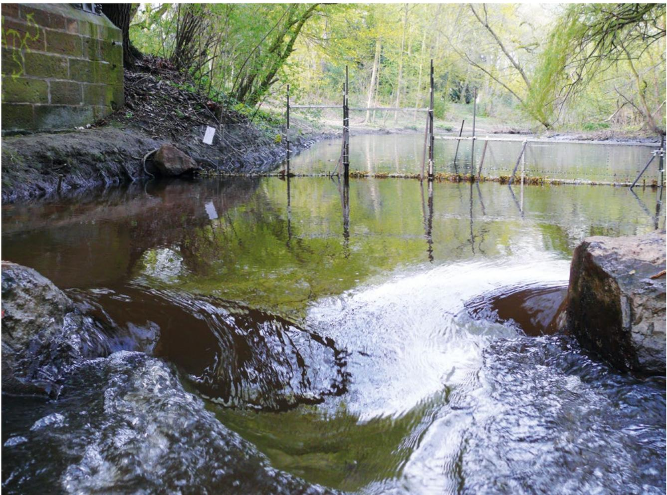
*Bild 7: Blickrichtung von unten (aus Aufstiegsperspektive) auf die Absperrvorrichtung aus dem obersten Steinriegeldurchlass aufwärts. Die Einstiegsöffnung in die Fangreuse befindet sich nicht sichtbar unter Wasser im dritten Rahmen vom rechten Ufer aus an der tiefsten Stelle (Foto: C. Frenz, Ratsgymnasium Minden)*
