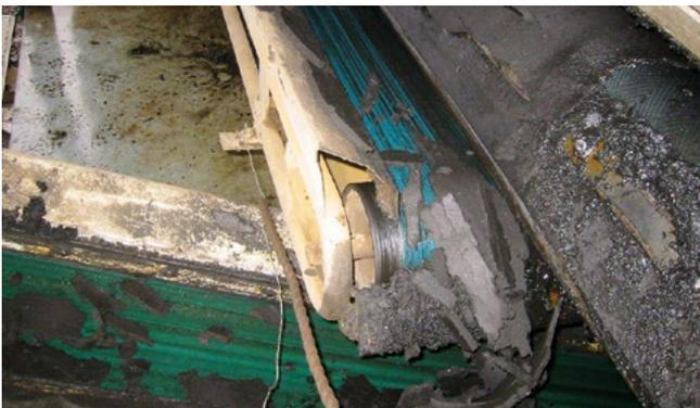
Bild 15: Walzen und Förderbänder: Das entwässerte Material kommt plattgedrückt in einer Stärke von 1 cm bis 2 cm aus der Siebbandpresse und weist dadurch eine plattige Struktur auf.
