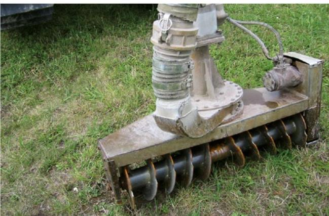
Bild 10: Anbaugerät „Schnecke“, 80 cm breit (Foto vom 20.7.2017)
