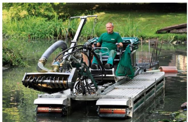
Bild 13: Kompletgerät mit Schnecke und Schlauchleitung
