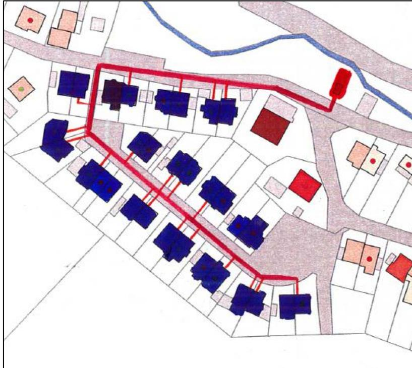
Abbildung 35 – Netzauslegung bei einer Anschlussdichte von 65 % (20 Gebäude)
