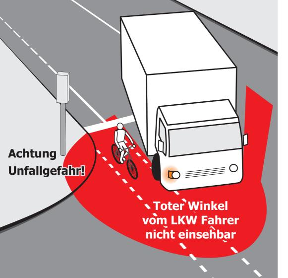
Den Bereich des "toten Winkels" (rote Fläche im Bild) kann der Fahrer des nach rechts abbiegenden LKW trotz der Außenspiegel an seinem Fahrzeug nicht einsehen.
