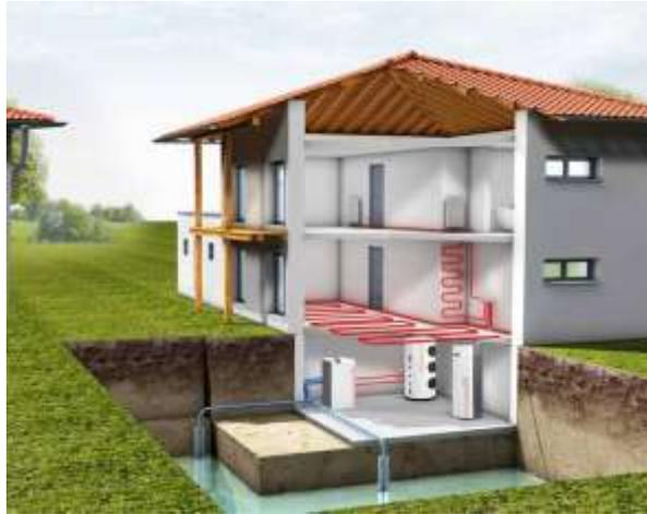
Wasser-Wasser (Grundwasser) Wärmepumpe
