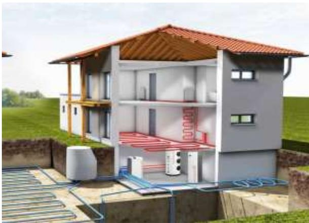
Erdwärme – Sole Wärmepumpe / Geothermie
