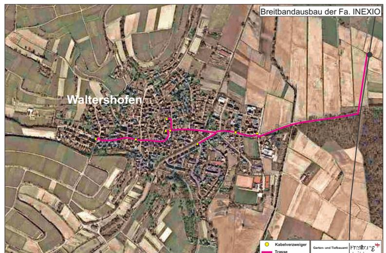
Das Schaubild zeigt den Trassenverlauf und die Kabelverzweiger, wie demnächst im Auftrag der Firma Inexio gebaut wird.
